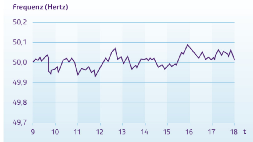
Typische Frequenzschwankungen im westeuropäischen Verbundnetz im Verlauf von mehreren Stunden. Die Abweichungen von der 50-Hertz-Norm sind geringer als 0,1 Hertz, da sofort die Primärregelung eingreift.
