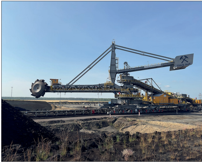
Abb. 5: Kombiniertes Haldenschütt- und Aufnahmegerät Ks-S 10000/6700.40, Gerätenummer 1835, Baujahr 2022 (Quelle: LEAG)
