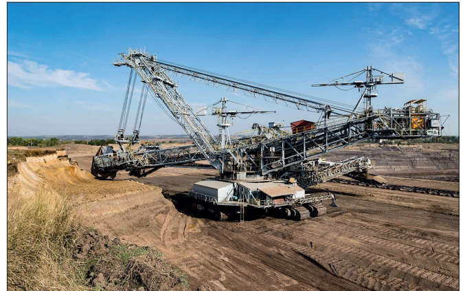
Abb. 2: Schaufelradbagger SRs 1200a, Geräte-Nr. 1447, Baujahr 1961 (Quelle: Romonta, Foto: Jens Schlüter)
