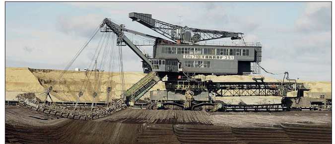
Abb. 4: Eimerkettenbagger ERs 710, Geräte-Nr. 351, Baujahr 1981 (Quelle: Prüfstelle DEBRIV, Foto-Archiv)
